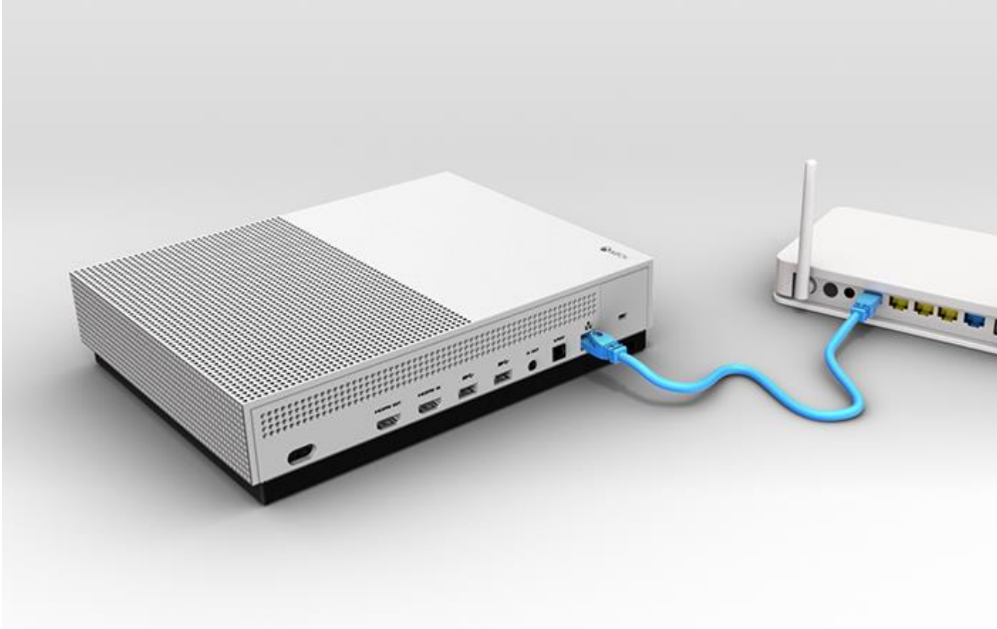
Łączenie oryginalnej konsoli Xbox One z routerem
